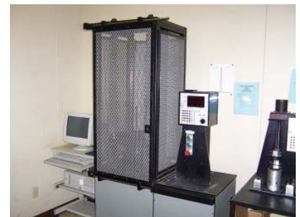
Comprobación de resortes controlado por computadora
